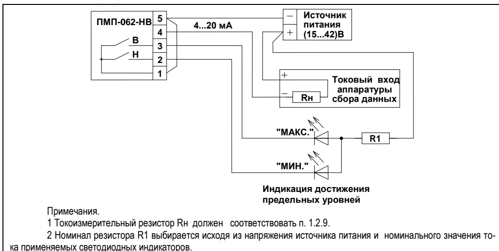
Рисунок 12 – Пример подключения ПМП-062-НВ
