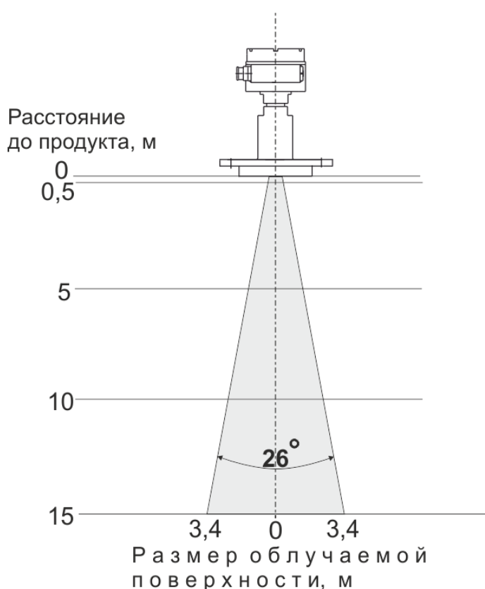
б) УР203Ех с рупорной антенной D = 50 мм и с диэлектрической антенной
